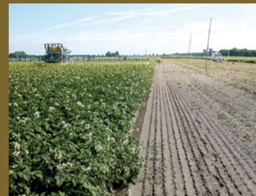
Met het Släpdukspuitsysteem spuit je op slechts 20 cm boven het gewas. Bij driftmetingen in aardappelen werden ten opzichte van standaard doppen driftreducties gevonden tot wel 99%. Hiermee kan dit systeem een alternatief zijn voor een bredere teeltvrije zone.
