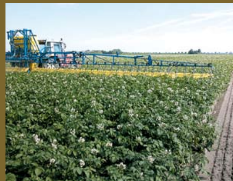
Met het Släpdukspuitsysteem spuit je op slechts 20 cm boven het gewas. Bij driftmetingen in aardappelen werden ten opzichte van standaard doppen driftreducties gevonden tot wel 99%. Hiermee kan dit systeem een alternatief zijn voor een bredere teeltvrije zone.
