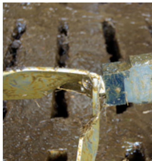
De schroef in open en dichte stand zodat hij toch tussen de roosters heen kan van minimaal 30 mm breed en 600 mm lang. Het kunststof glijlager (linker foto, blauw blokje) slijt makkelijk. Vervangen kost 25,87 euro.
