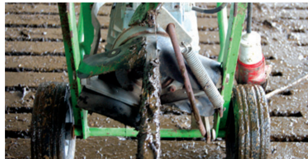
Via de veer is de roostermixer klem te zetten aan de roosters. Onder de motor is een deel van de as bloot om de propeller voor de spleet te draaien.
