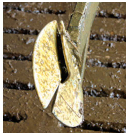
De schroef in open en dichte stand zodat hij toch tussen de roosters heen kan van minimaal 30 mm breed en 600 mm lang. Het kunststof glijlager (linker foto, blauw blokje) slijt makkelijk. Vervangen kost 25,87 euro.
