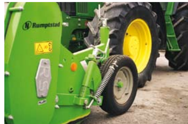
De Multivator van Nico Koeckhoven en Jan-Christiaan Avis is uitgerust met een rugvormer. Met de voorste spindel is de hoogte van de rug traploos in te stellen.
