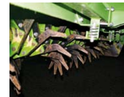
Omdat de grond in het voorjaar vochtig is, staan de haken minder schepend dan die van een rijenfrees. Zo versmeert de grond minder.
