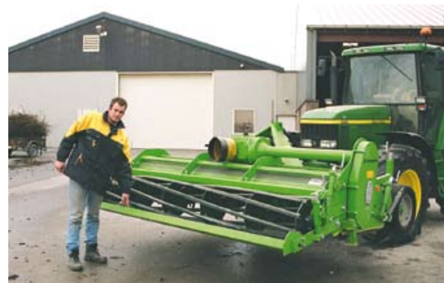
Jan-Christiaan Avis wijst de egalisatiebalk aan, ook wel koppensneler. Deze strijkt de koppen van de sneden vlak. De hoogte is traploos instelbaar
