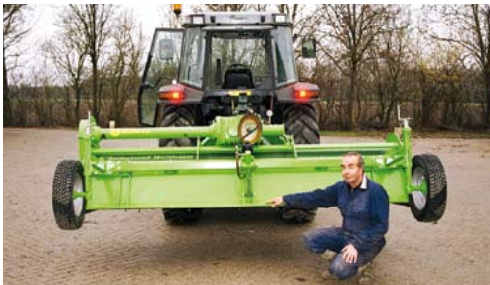
Omdat Rien van Beusichem de Multivator in eerste instantie voor het klaarleggen van spruitenland heeft aangeschaft, zit er achterop de machine een vlakke plaat in plaats van rugvormers.
