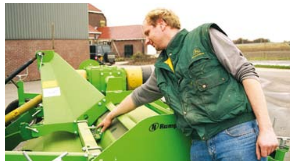
Hugo Pruisen, medewerker van Koeckhoven, wijst een van de veren aan van de kap. De veren zorgen ervoor dat de kap trilt zodat de grond niet aankoekt tegen de kap.
