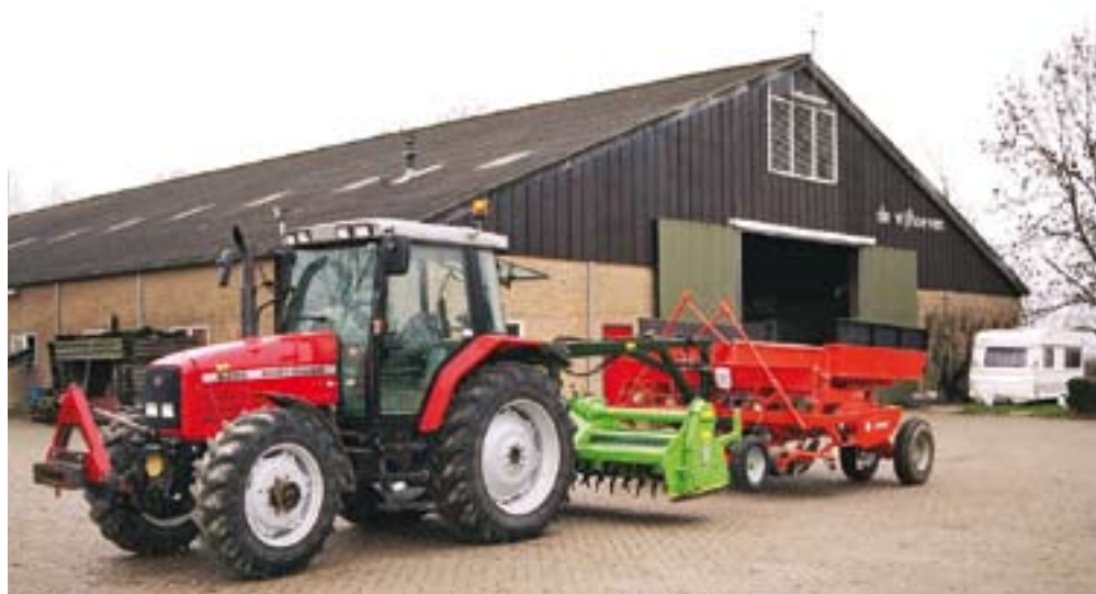
De combinatie van Rien van Beusichem. De Multivator is bijna kaal, alleen de werkdiepte kan ingesteld worden via de stelwielen.
