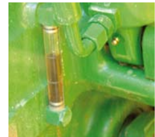
Controleer bij het oliepeil ook de kleur. Dit kan in het kijkglas en moet heldergeel zijn.
