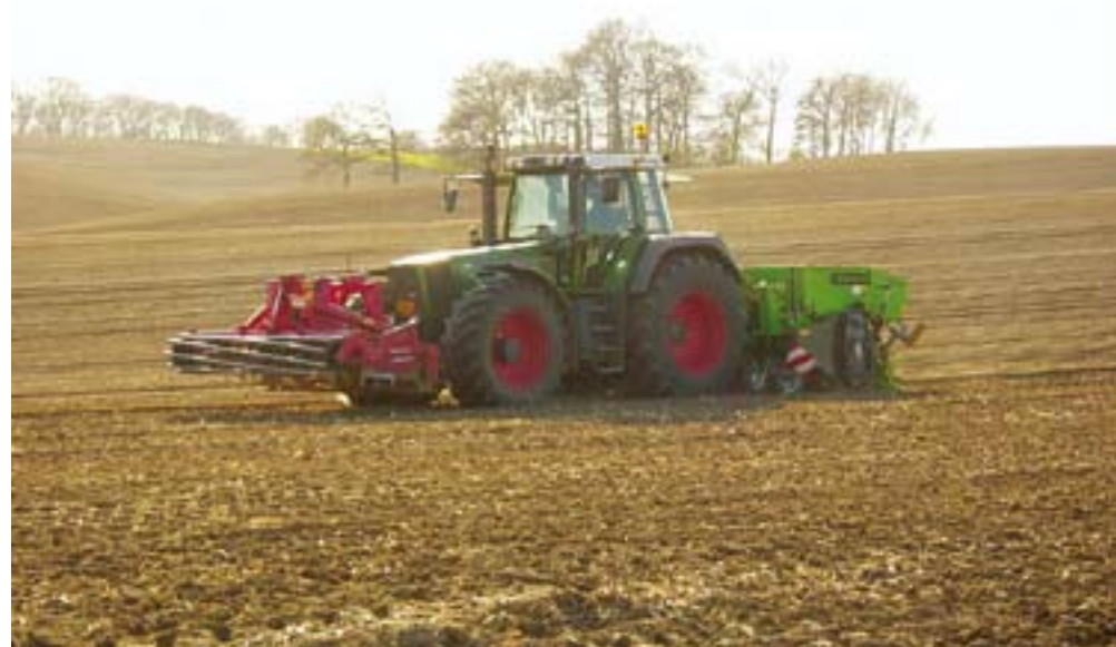
Bij de teelt van aardappelen op de zware gronden kan er gekozen worden voor de combinatie van pootbedbereiding, poten en rijenfreesen.
