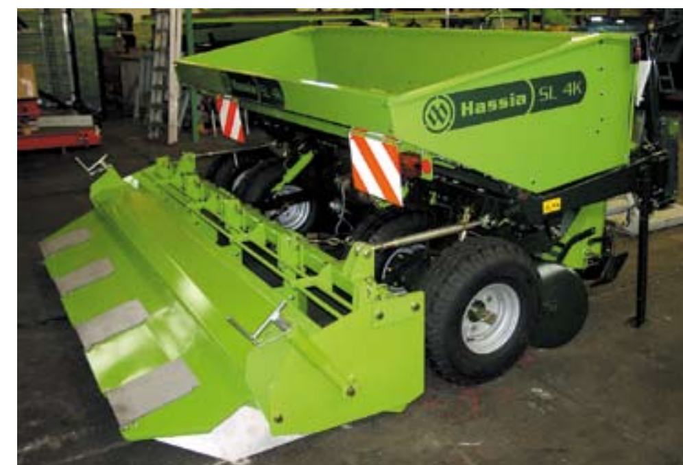
Net klaar in de fabriek van Miedema, een Hassia pootmachine met Speedrigger aanaardkap voor het gelijk opbouwen van de aardappelrug. De pootmachine rechtstreeks vullen vanuit de kipper gaat niet, wel via een hydraulisch transportbandje achter de kipper.
