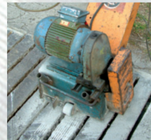
Twee lamellenfreesen. Links de gewone en rechts de zware. Vooral de laatstgenoemde maakt de vloer voldoende stroef.
