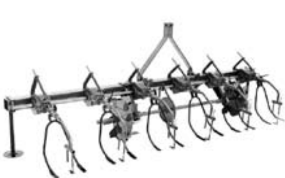
Een zesrijige aanbouwslingerdunner met aandrijving door de loopwielen. Inzet: Het aandrijfmecanisme: van roterend naar pulserend.
