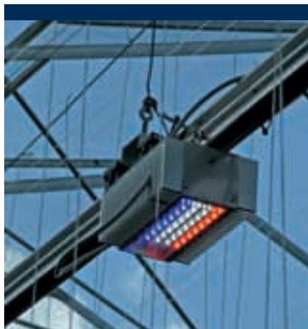
De cluster verlichting bevat in deze proef 32 lampjes in een compacte lichtbak.
