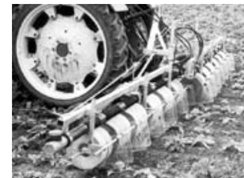
De Homburg onkruidstrijker bestaat uit twee geperforeerde buizen van elk 3 m, bekleed met doek. Op elke deel zit een elektromotor die de buis ronddraait en zo verhindert dat het doek gaat druppelen. In de buis zitten tussenschotten om verschil in dosering op hellend terrein tegen te gaan. Om ook in gewassen met minder hoog opgaand onkruid toch met glyfosaat te kunnen werken, is de Homburg rol uit te breiden met extra rollen van schuimplastic die de stroken behandelen. De rijen met cultuurplanten worden daarbij wel afgeschermd.
