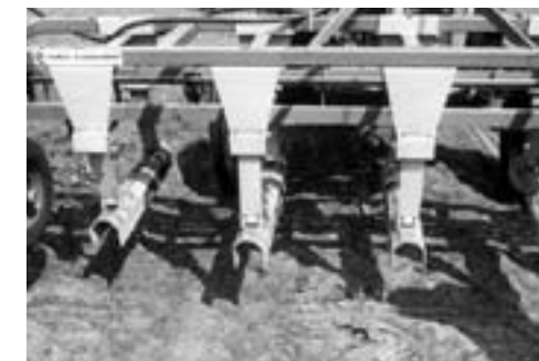
De nog jonge bieten of uienplantjes worden met een tunnel afgeschermd, waarna het resterende oppervlak wordt behandeld met een allesdodend middel.
