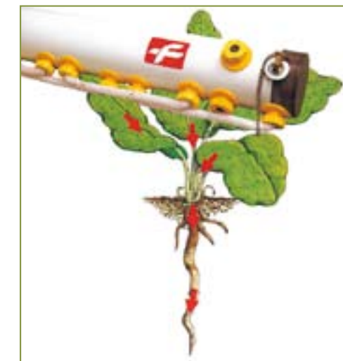
De onkruidstrijker van Fritzmeier. Op de gaten van de kunststof buis zitten schroeven, waarin koordstukken worden geklemd. Door de capillaire werking wordt het koord doordrenkt met glyfosaat. Als op een perceel veel onkruiden aanwezig zijn, is de afgifte groot en droogt het koord uit. Om dat tijdig aan te vullen, kan de buis naar beneden worden gedraaid.
