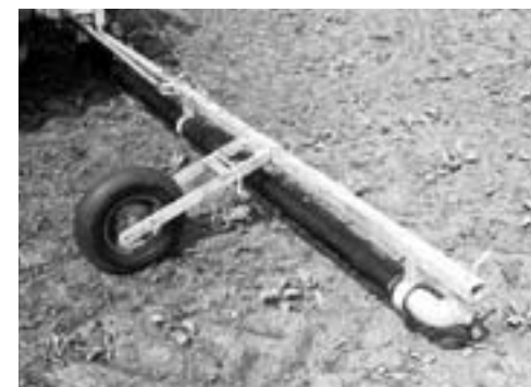
De Homburg onkruidstrijker bestaat uit twee geperforeerde buizen van elk 3 m, bekleed met doek. Op elke deel zit een elektromotor die de buis ronddraait en zo verhindert dat het doek gaat druppelen. In de buis zitten tussenschotten om verschil in dosering op hellend terrein tegen te gaan. Om ook in gewassen met minder hoog opgaand onkruid toch met glyfosaat te kunnen werken, is de Homburg rol uit te breiden met extra rollen van schuimplastic die de stroken behandelen. De rijen met cultuurplanten worden daarbij wel afgeschermd.
