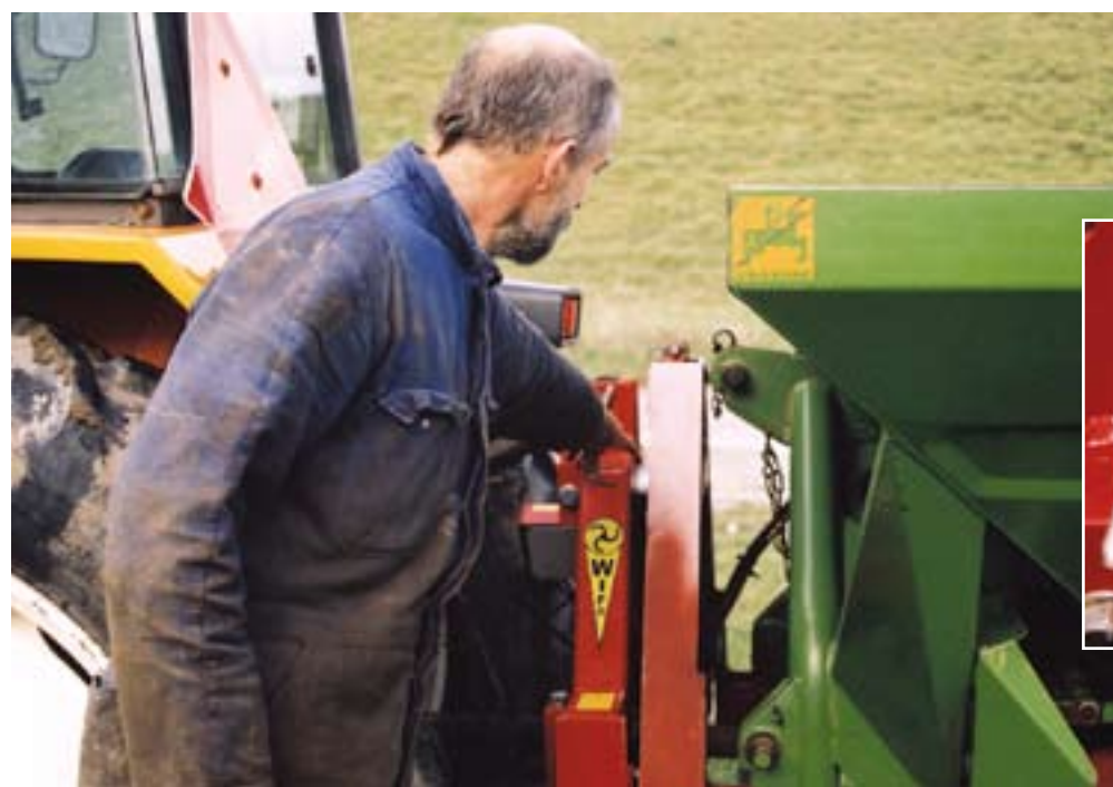
Akkerbouwer Daniël Dekker uit Biervliet wijst de bovenste weegsensor aan die zorgt voor het corrigeren tijdens excentrisch heffen.
