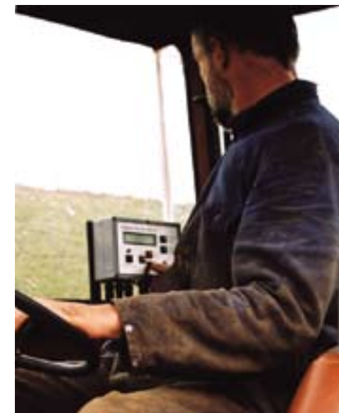
De strooierinstellingen kunnen makkelijk gewijzigd worden met de strooi-computer.
