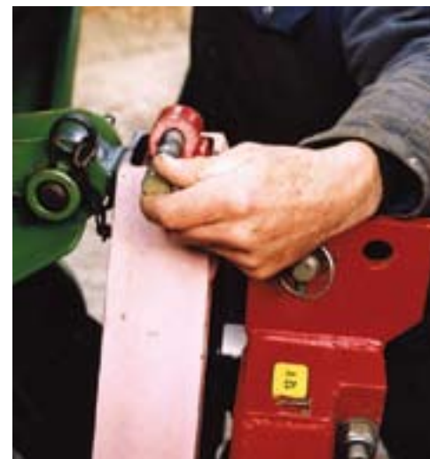
Het ontgrendelen van de weegbok gebeurt door de pen uit de borging te halen. Zo is het werktuig snel af te koppelen. Na het ontgrendelen is het een kwestie van de bak te laten zakken en de aftakas los te koppelen. Denk wel om ook de bedrading naar de strooicomputer los te maken.
