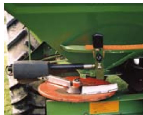
Het openen en sluiten van de doseerklappen gebeurt vanuit de cabine. Hier staat de doseerklap open.
