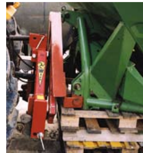
Het ontgrendelen van de weegbok gebeurt door de pen uit de borging te halen. Zo is het werktuig snel af te koppelen. Na het ontgrendelen is het een kwestie van de bak te laten zakken en de aftakas los te koppelen. Denk wel om ook de bedrading naar de strooicomputer los te maken.
