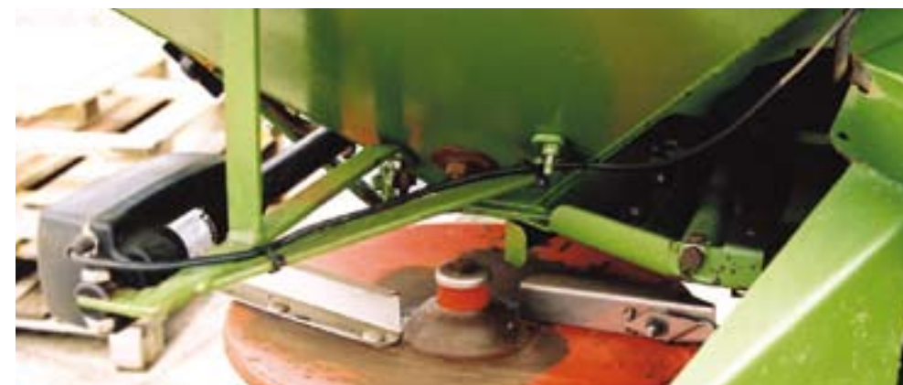
De spindelmotoren zijn eenvoudig te monteren op een bestaande strooier. Nadeel is wel dat de bedrading bloot ligt en zo makkelijk beschadigt.
