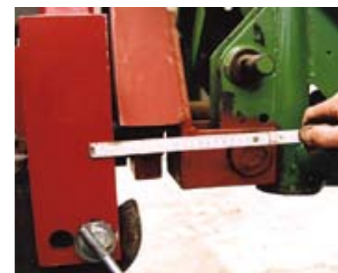
Met de driepuntsweger is er wel aanbouwverlies. De afstand van de kogels van de hefinrichting tot de aanspanning van de kunstmeststrooier is 20 cm.
