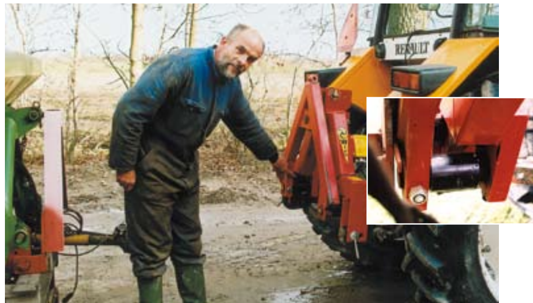
Eén van de twee onderste weegsensoren van de weegbok. Daniël Dekker gebruikt de weegbok ook voor de uienplanter.
