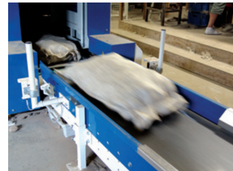
Met hoge snelheid gaan de zakken de machine in. De aanvoerlijn is op de capaciteit van de palletiseermachine afgesteld.
