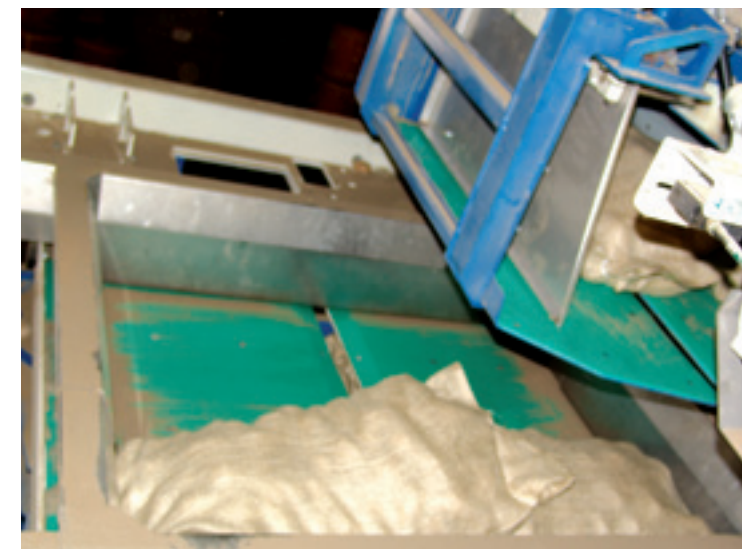
De zakken worden vanuit de vulbak op de laadschuiven neergelegd. Is er een laag compleet gelegd, dan gaan de laadschuiven naar buiten toe en vallen de zakken op het pallet.
