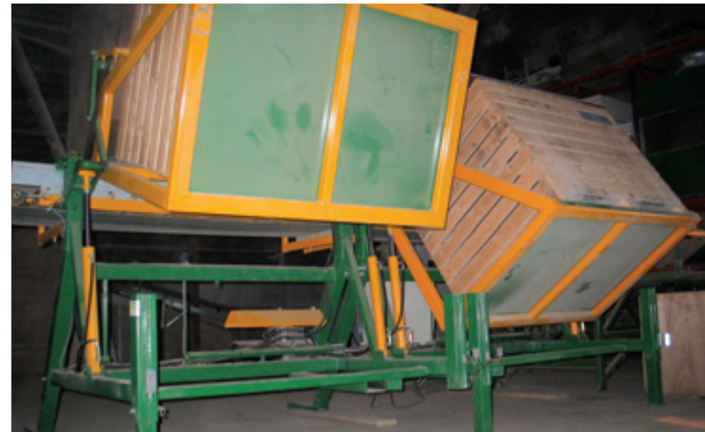
De kist die aan de linkerkant van de machine is geplaatst, wordt gelost. De kist aan de rechterkant is alvast in de wachtstand gezet.
