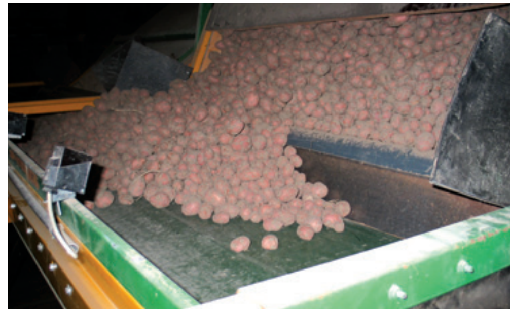
Een geringe valhoogte en daarbij minimale kans op versmering zijn voor de huidige gebruikers belangrijke argumenten geweest bij het aanschaffen van de machine.
