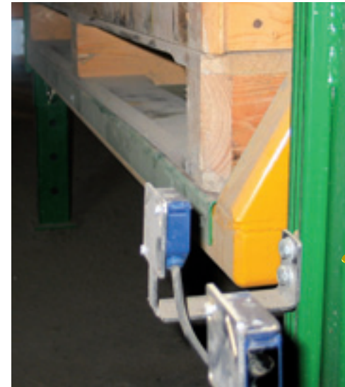
Een sensor ter hoogte van de palletopening van de kist neemt waar wanneer de heftruckvorken de kist verlaten.
