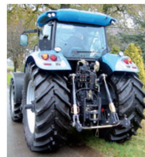
Nog een verschil met de XTX. De Landini heeft standaard steekassen voor spoorbreedteverstelling tussen 1,73 en 2,07 meter. Daarbij zit de airco achterop de cabinerand en zijn er vijf dubbelwerkende ventielen.
