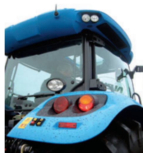
De Powermaster heeft meteen de nieuwe achterlampen gekregen die McCormick ook al heeft. Er is aftakas- en hefbediening op het spatbord aan beide zijden.
