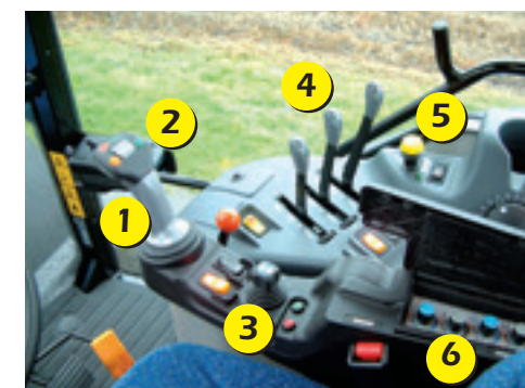
De cabine is onmiskenbaar van Landini en verschilt dus van de XTX. Vooral de aansturing door een tuimelschakelaar van de achttrapspowershift valt op. In de meest luxe XTX zit in tegenstelling tot de Landini geen dwarsstijl in de vooruit.
