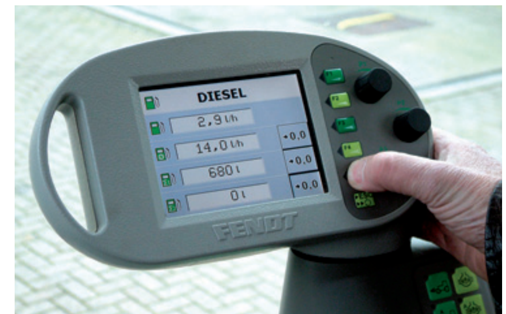
Op de terminal van een Fendt 916 vario TMS is het verbruik af te lezen. Met 1.000 toeren gebruikt deze trekker 2,9 liter per uur. Daaronder staan gemiddelde waarden. "Met 150 uur op de klok is de trekker nog niet ingereken (pas bij 500 uur) en kan daardoor maximaal 3% meer verbruiken", aldus Abemec Veghel.
