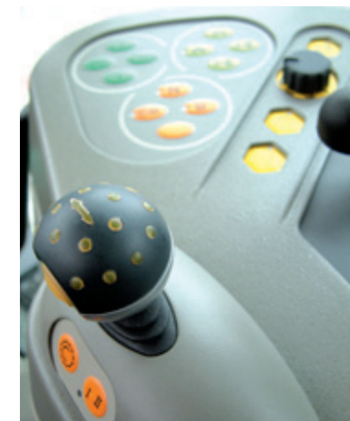
Het meest opmerkelijke onderdeel in de cabine. De twee versnellingspoken hebben plaats gemaakt voor een klein bolletje waarmee je traploos voor- en achteruit kunt versnellen. Met de tip-toetsen ernaast kun je de transmissie programmeren.
