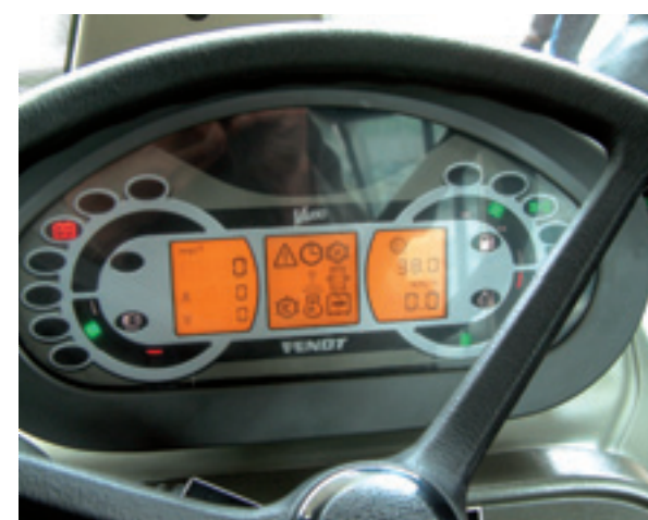
Op het dashboard van de Fendt 312 Vario zijn alle instellingen van de transmissie te bekijken.
