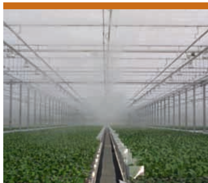
Met de dubbelzijdige nozzles op één straal van 160 meter lengte kan de teler een kap van 13,5 meter breed egaal benevelen.
