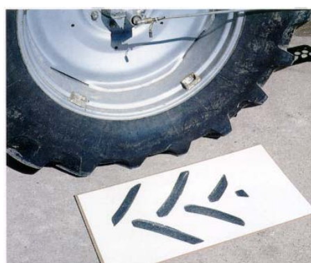
Bandenspanning 1,2 bar (onnodig hoog)
