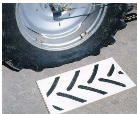
Bandenspanning 0,5 bar volgens tabel! (Foto's: Team Reifenregler)
