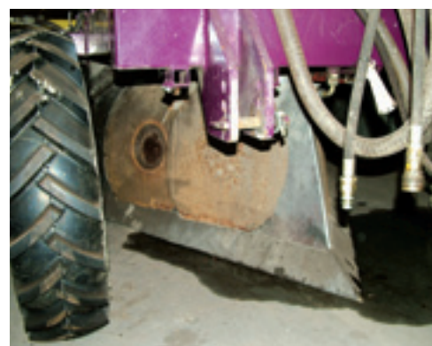
De 'boot' maakt het plantbed. Aan weerszijden van de voet zitten twee rond-draaiende schijven die zorgen voor de zijwaartse verplaatsing van de grond.
