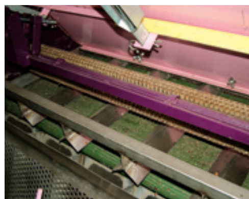
De trillende dakjes zorgen ervoor dat de bollen uit elkaar getrokken worden. De tegendraaiende borstel wrijft de bollenlaag egaal wat bijdraagt aan een optimale verdeling van de bollen.
