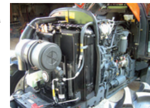
Onder de naar boven klappende motorkap ligt een bekende krachtbron; de Perkins 1004C-44T. Een moderne viercilinder dieselmotor met turbo.
