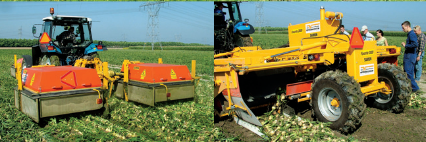
Boven: Dewulf zelfrijdende klembandrooier voor peen. De kunststofkloppers voor het losschudden van de grond staan haaks op de trekbanden. Onder: Drie bedden uien tegelijk, Samon demonstreerde dit bij zowel het klappen als het rooien. Bij de hydraulisch aangedreven rooier is het middelste bed te verdelen over de twee buitenste zwaden met een verdeelbandje. Hierdoor kun je sneller oprapen. Het verdeelbandje is overigens ook te demonteren.
