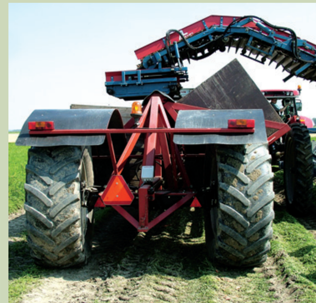
Via een dwarsband aan het eind van de afvoerband kan de AsaLift peenrooier lossen in de meerrijdende wagen met een dubbele rij kantelbare kisten.
