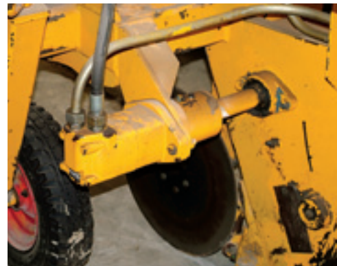
De zeefmatten bij de rooier worden hydraulisch aangedreven door hydro-motoren. Deze zijn traploos in snelheid te regelen.
