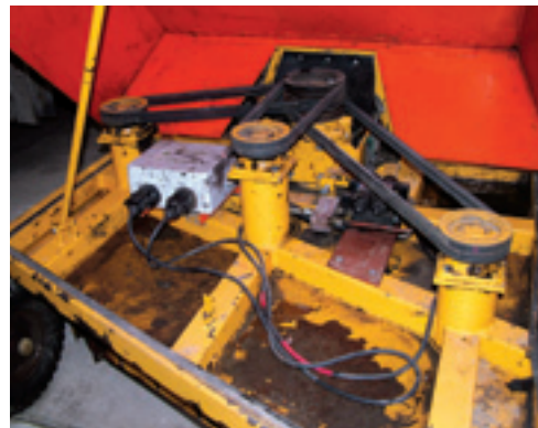
De aandrijving van de messen gebeurt bij de klapper met V-snaren. De elektrische kast dient voor de automatische hoogteregeling.
