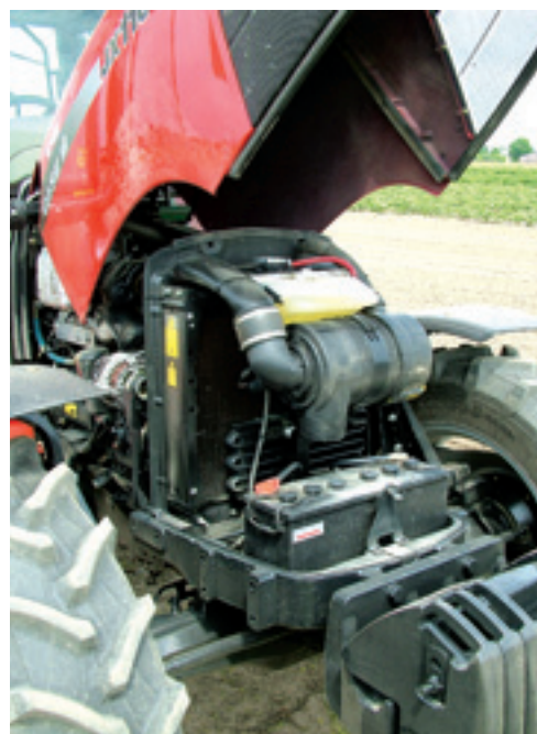
De motorkap gaat royaal open. De onderdelen voor zowel het dagelijks als het periodieke onderhoud (filters) zijn prima bereikbaar.
