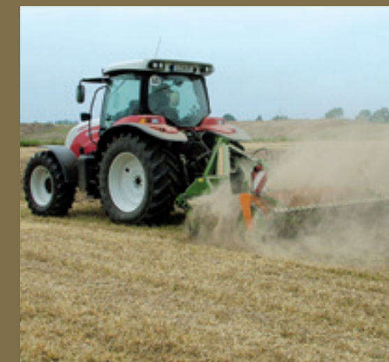
Voor de eerste stoppelbewerking tot 6 cm is een schijveneg beter geschikt dan een cultivator omdat hij zich uitstekend aanpast aan oneffenheden in het maaiveld.
