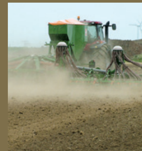
De Amazone Cirrus zaaimachine heeft een zaaielement met twee schijven en een instelbare belasting tot 50 kg per schaar. Een balk met tanden strijkt de zaaivoren dicht. De capaciteit is hoog met een werkbreedte van 12 m en een zaaisnelheid van 15 km/h.
