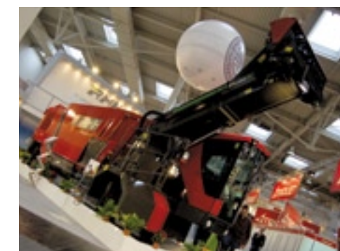
RMH ontwikkelde de nieuwe Mixellent verticaal mengende, zelfrijdende voermengwagen. Er is een 30 kuubs versie leverbaar.
