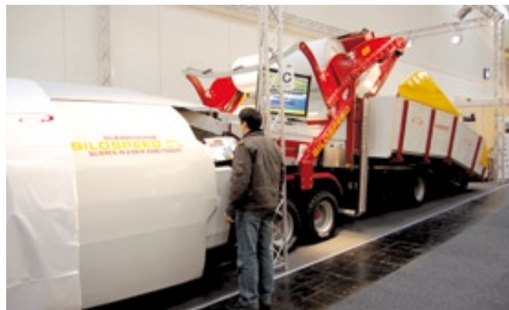
Het Oostenrijkse Silospeed kuilt voer in met een machine en gangbaar plastic op rollen. Er zijn dus geen speciale slurven nodig.
