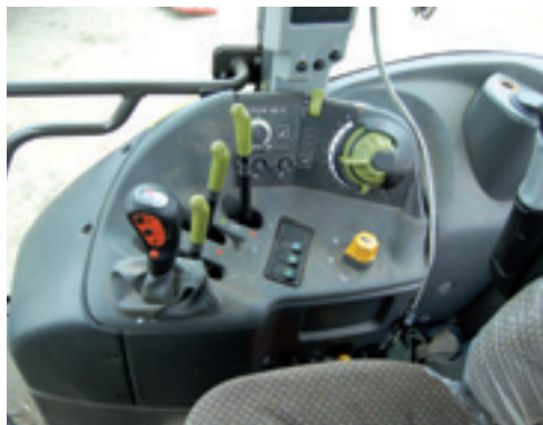
Versnellingshendel voor Hexashift transmissie op de voorgrond. De drie grote, groene hendels zijn voor de bediening van de dubbelwerkende hydraulische ventielen.
