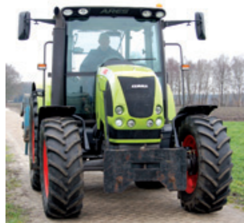
Extra breedstralers en een DIN-plaat voor aanbouw van onder meer een rolbezem geven de trekker een aparte uitstraling. Vanwege de beddenteelt staat de trekker op een spoorbreedte van 1,80 m.
