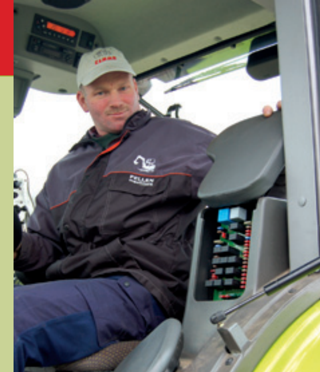
John Kelders: "Het rijden is een genot met een automatisch werkende airco, luchtgeveerde stoel en geveerde cabine." Achter de rugleuning van de bijrijderstoel zit de kast met zekeringen.
