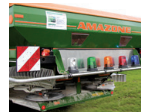
De Amazone ZA-M met DGPS waarbij de variatie in strooihoeveelheid werd zichtbaar gemaakt met de verschillende kleuren zwaailampen.
