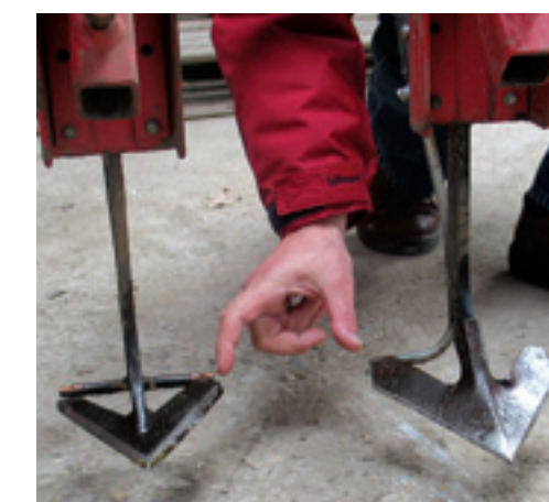
De Pneumat blaast het onkruid in de rij weg via twee persluchtstralen die zich ter hoogte van de gewasrij raken. De spuitmonden moeten dus tegenover elkaar staan. Hoe dichter de schoffels bij elkaar staan, hoe minder perslucht er nodig is.
