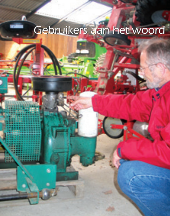
De Pneumat krijgt lucht via een aftakas aangedreven schroefcompressor. Onkruidonderzoeker Piet Bleeker wijst de stelschroef aan waar de druk mee geregeld kan worden.
