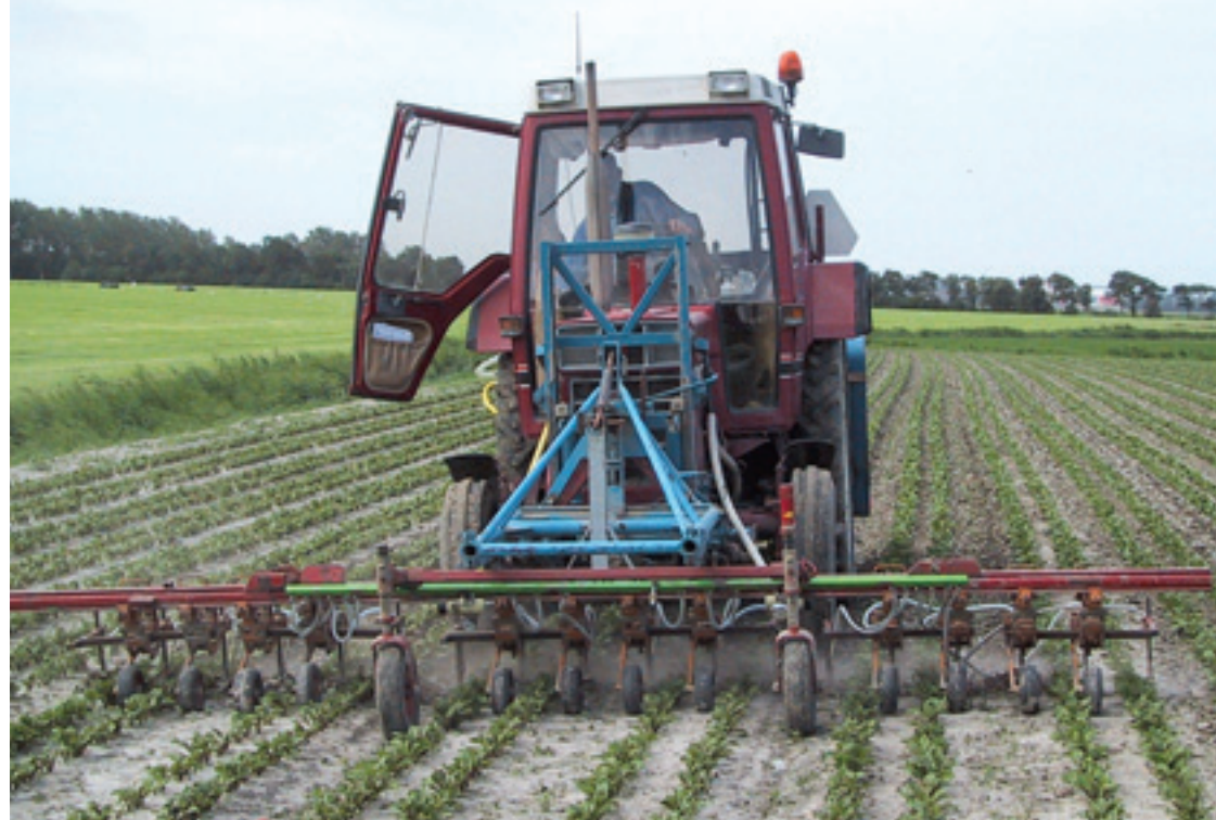
Renze Hoekstra maakte zelf een 15-rijige pneumatische schoffel voor drie bedden van 1,5 m rode bieten en uien. Hij kocht apart de schoffelmessen met blaasmonden en een mobiele compressor.
