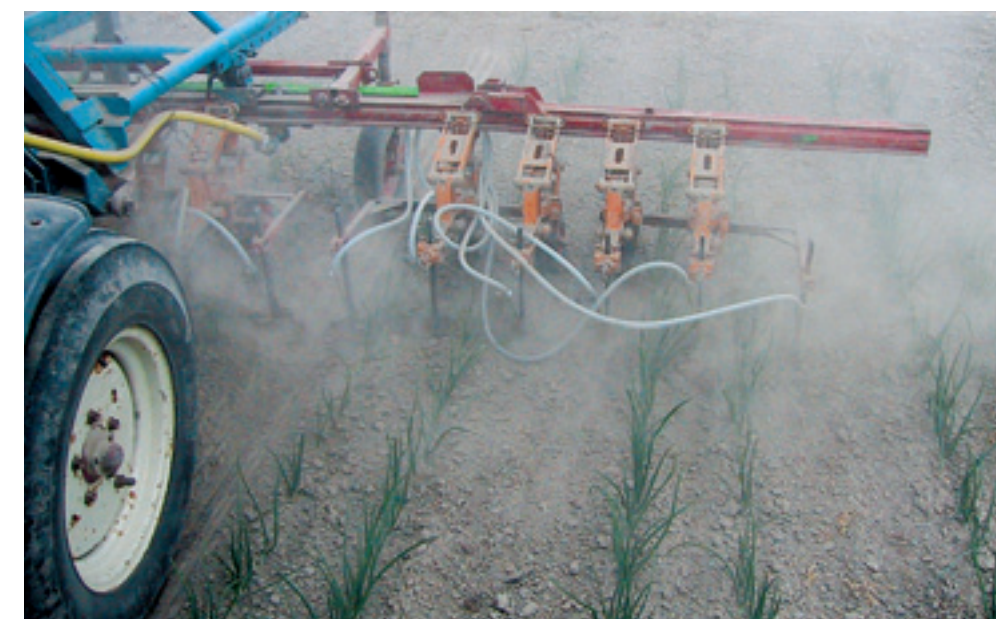
De Pneumat van Renze Hoekstra onder droge omstandigheden in uien. Iedere twee parallellogrammen zijn met elkaar verbonden waardoor de spuitmonden altijd tegenover elkaar staan.
