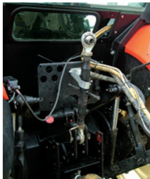
Een bundel kabels en snoeren uit de cabine. Bij de aanschaf van de veldspuit in 1998 was dit gebruikelijke manier om de signalen van de RDS-spuitscomputer over te brengen naar de spuitmachine.
