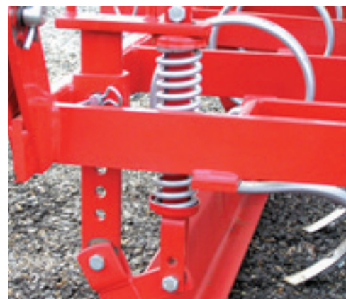
De egalisatieplaat kan op tien verschillende hoogte-afstanden ingesteld worden. De veer geeft enige tegendruk. De hoek van de plaat met de grond is in twee standen verstelbaar.
