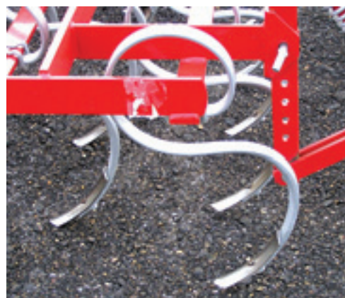
De SQ-tand van Kongskilde. Deze is stugger dan de S-tand. De beitel is omkeerbaar heeft een werkbreedte van 3,5 cm.
