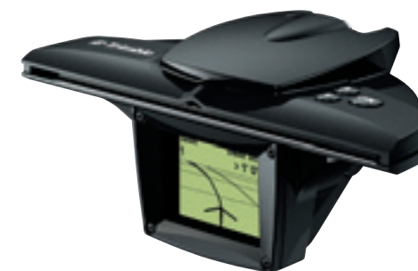
Op GPS recht rijden is niks anders dan rijden op een rij lampjes of over een virtuele lijn die je ziet op het beeldscherm in de trekker.
