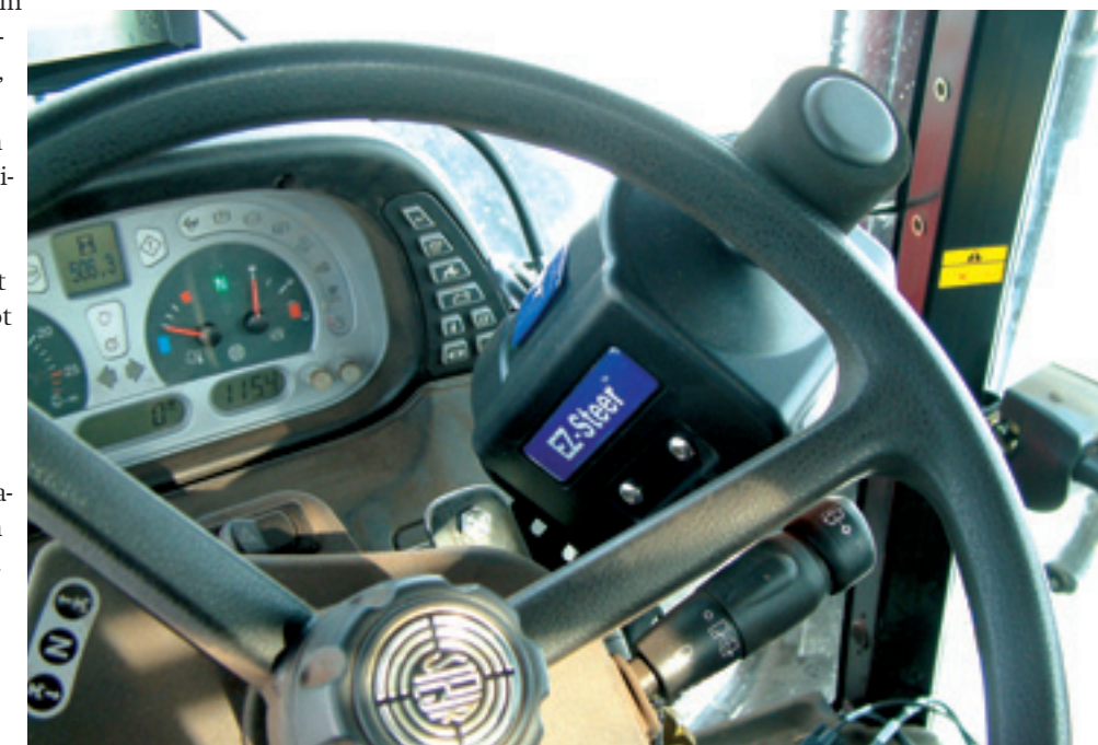
Bij sommige systemen kan de trekker ook zelf sturen. Een hydraulische cilinder neemt dan het sturen over. Bij de EZ-steer van Trimble komt er een kastje met een wiel onder het stuur die het sturen overneemt.
