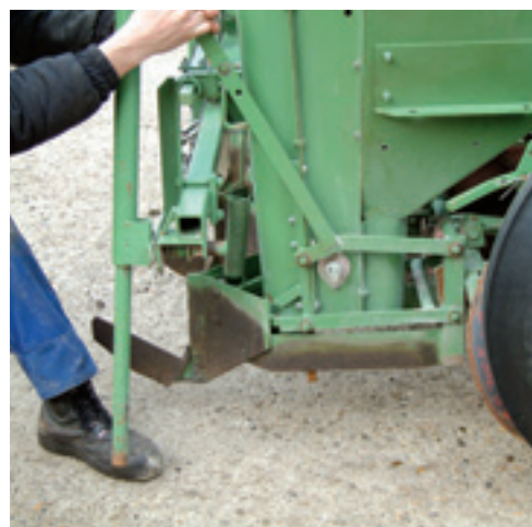
Om een rij uit te schakelen van de GLB 4, moet je de aandrijving uitschakelen en de betreffende vorentrekker omhoog zetten.
