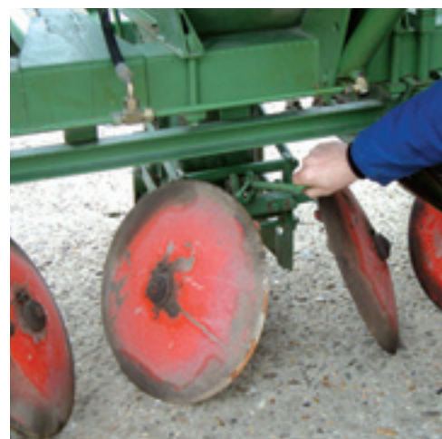
De druk op de toedekschijven is bij de oude GLB 4 traploos in te stellen met een draaispindel.
