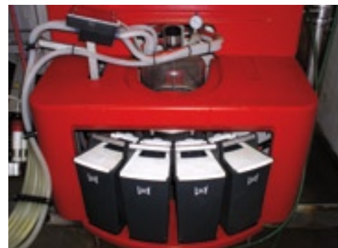
Melkcontrole vindt plaats in het kastje linksboven op de foto. Bij afwijkende waarden wordt de melk geseperreerd in één van de vier separatiebakken.
