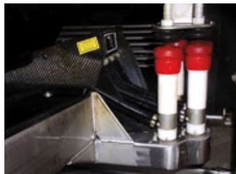
Na elke melkbeurt worden de tepelbepers gereinigd. Hiervoor wordt koud water en optioneel stoom gebruikt.
