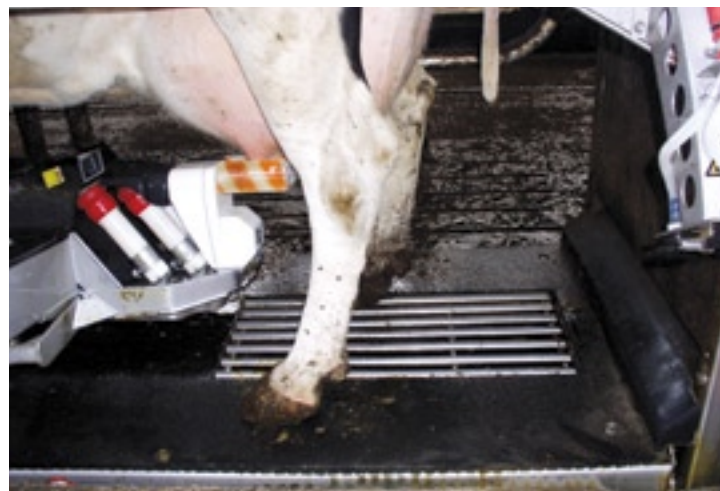
Door het kleine rooster in de rubbervloer wordt de mest afgevoerd en staat de koe iets met haar poten gespreid. De tepelbekers staan afgedekt in de stand-by-stand.
