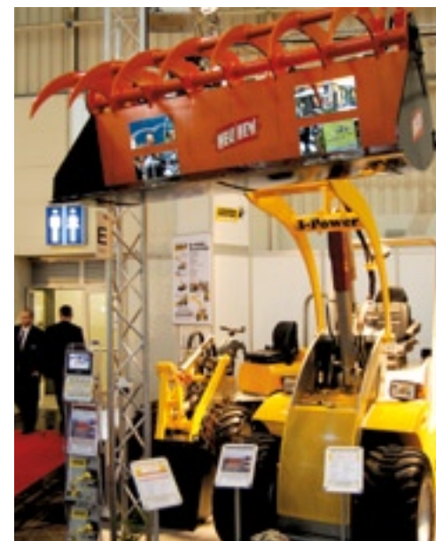
Frank Föckersperger kuilhapper met uitschuifwand.
