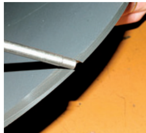
Het controleren van de celdiameter van de zaaischijf door middel van een meetstiftje. Past het smalle gedeelte in een cel, dan is de schijf aan vervanging toe.
