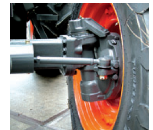
Door de fusee-ophanging van de vooras is er een grotere bodemvrijheid en een korte draaicirkel.
