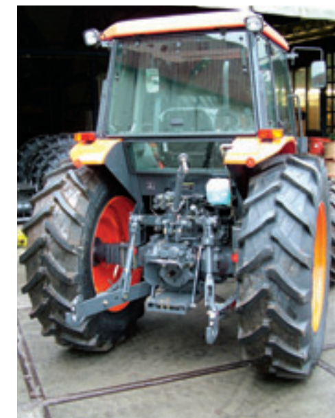
Spatbordverbreeders zijn optie, net als een verstelbare boventrekhaak. Opvallend is de trekkrachtregeling via een pen-gatverbinding op de achterbrug. Met twee hulpcilinders tilt de hef 4 ton.
