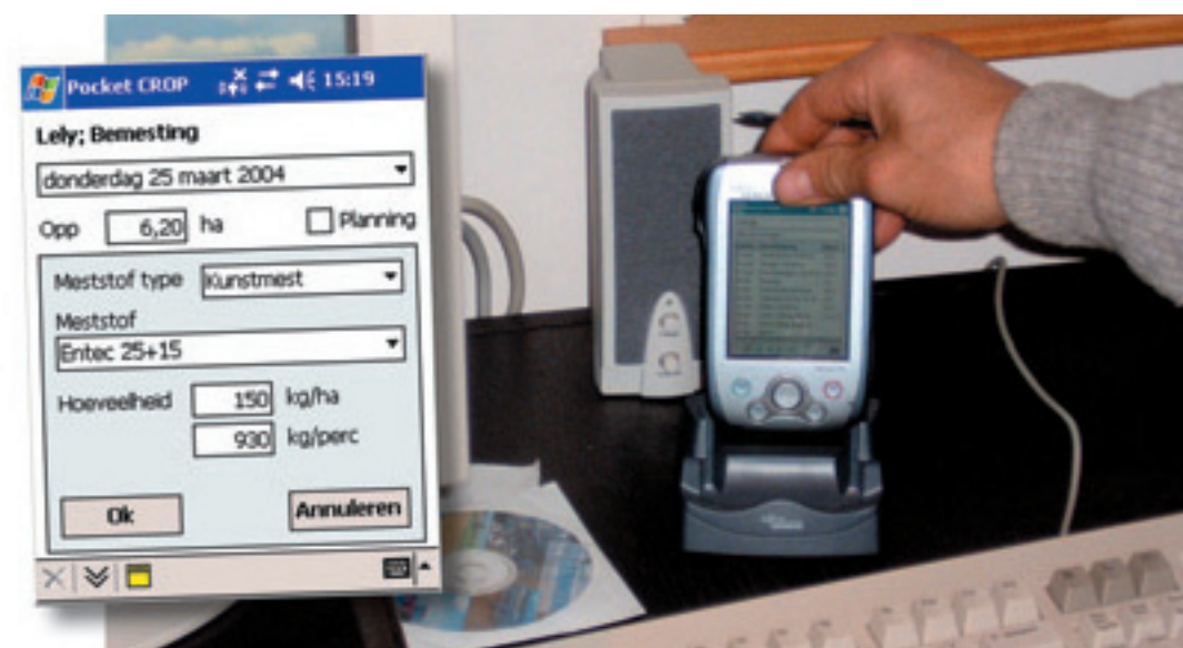
Wanneer de pocket pc in de stander wordt gestoken, vindt overdracht plaats van nieuw ingevoerde gegevens.
