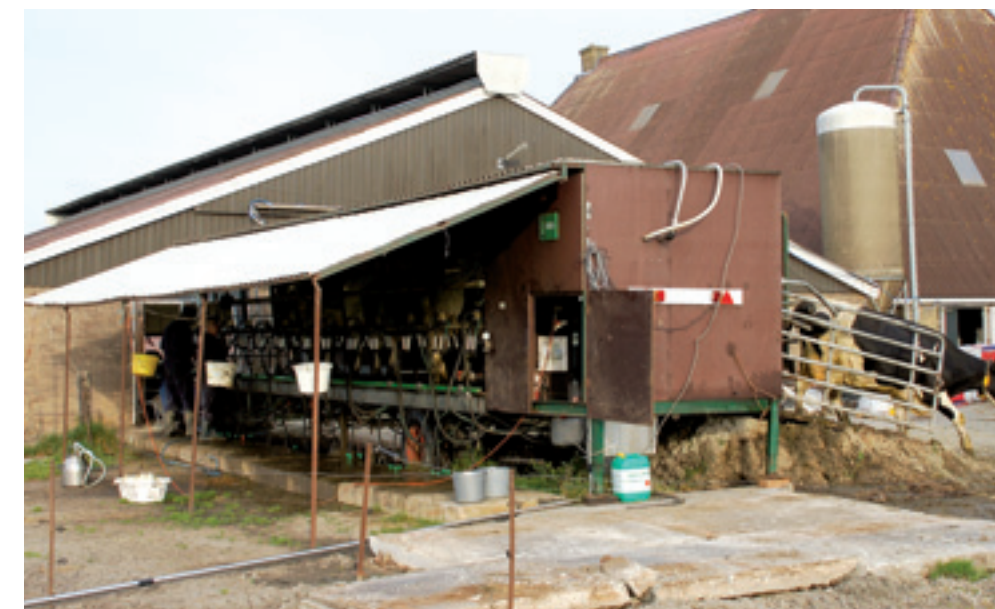
WestfaliaSurge dealer MCN Drachten bouwde zelf een dertienstands doorloopwagen. Het is een eenvoudige wagen zonder melkmeters en voerbakken.
