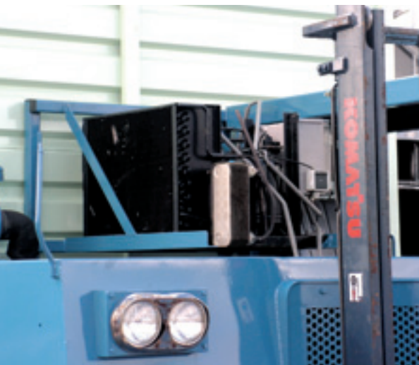
De koelmotor is naast de bestuurderscabine gemonteerd.
