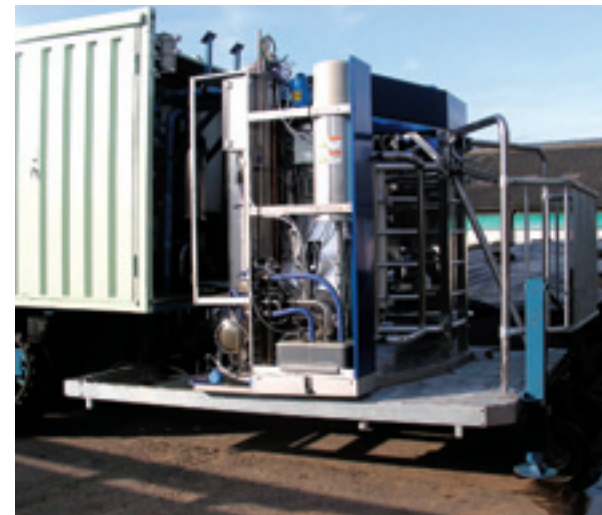
De DeLaval VMS melkrobot hangt achter de machine in de lepels van de hefmast. Het plateau is nu nog te zwaar. Daarom ondersteunen twee wielen tijdelijk het plateau.
