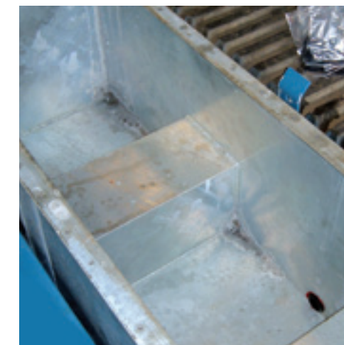
Een 1.000 liter grote waterbak is onder het frame gemonteerd. Hierin wordt het spoelwater opgevangen.
