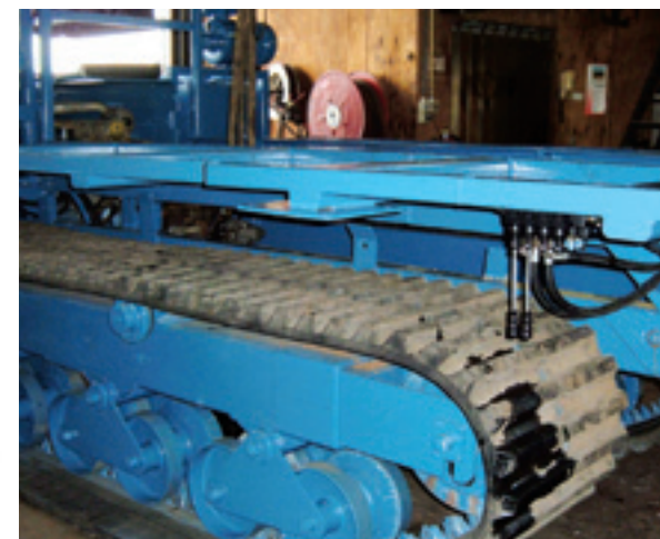
Het onderstel van de rupsdumper is voorzien van rubber rupsen en weegt inclusief motor en bestuurscabine 6.900 kg. De totale zelfrijdende melkrobot weegt bijna 10.000 kg.
