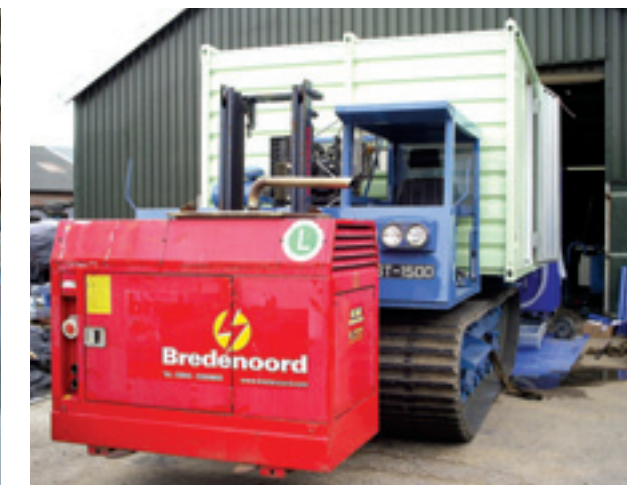
In de hefmast voor de mobiele melkrobot hangt een aggregaat die voor de stroomvoorziening van de hele machine zorgt.
