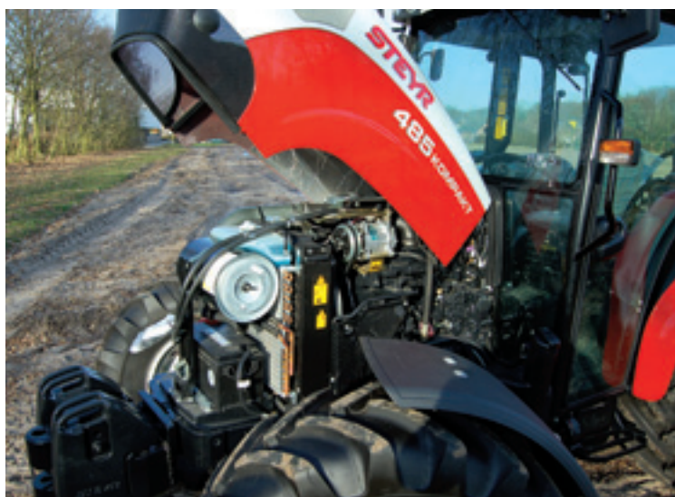
Bij de viercilinder Kompakt zit het distributiehuis van de motor aan de cabinezijde in plaats van aan de voorzijde bij de drieclinders. De motorkap kun je met een druk op de knop openen.
