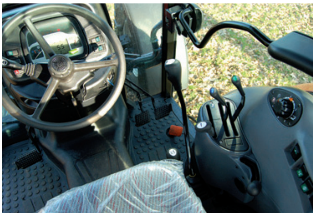
Net zoals andere merken heeft ook Steyr zijn best moeten doen om de hendels goed te plaatsen in de cabine van een compacttrekker met de beperkte ruimte. Met het gaspedaal is dit mislukt. Het zit te ver naar rechts zodat je met het rechterbeen tegen de versnellingshendel leunt.
