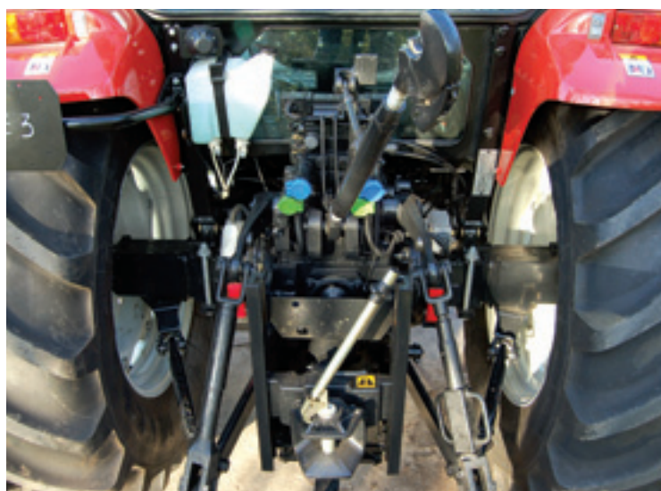
Het zicht op de vanghaken is prima. Je kunt de hef dan ook bedienen via knoppen op beide spatborden. Linksboven het vloeistofreservoir voor de ruitensproeier.
