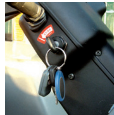
Links naast de contactsleutel de gecodeerde sleutel met afstandsbediening. LMB Roelofs uit Bennekom is verantwoordelijk voor de inbouw in New Holland trekkers.
