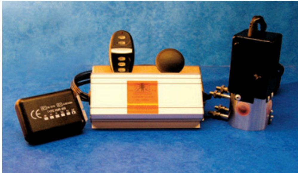
Mechatrac levert een systeem waarbij alle elektronica voor de beveiliging in een kastje ter grootte van een zakagenda zit. Deze wordt ergens onder een paneel gemonteerd. Op een raamstijl of het bedieningspaneel wordt het 'keyboard' bevestigd voor de inactivering van de beveiliging. Als de contactsleutel uit het slot wordt gehaald, treedt de beveiliging na 20 seconden in werking.
