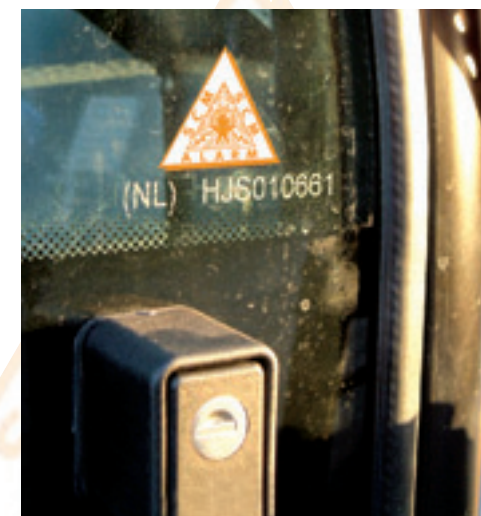
Een prima herkenningsteken, het motornummer in de vier ruiten van de cabine gegraveerd: onuitwisbaar. Met de driehoekige sticker worden 'bezoekers' geattendeerd op de aanwezigheid van een beveiligingssysteem en ook dat schrikt af.
