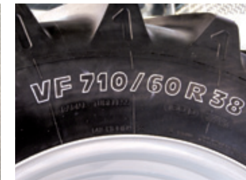
▲ Op de zijkant van de extra flexibele banden staat met de letters IF (improved flexion) of VF (vary flexion) aangegeven dat de band respectievelijk 20 of 40 procent meer afplatting toelaat.
