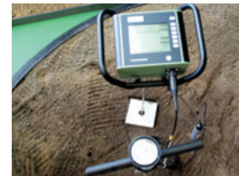
▲ Voor het meten van de draagkracht van de bodem en opsporen van grondverdichtingen is een penetrometer een goed hulpmiddel. Ze zijn er in verschillende uitvoeringen. Van een eenvoudige meter, tot een logger die van verschillende lagen de weerstand weergeeft op een scherm of op papier.
