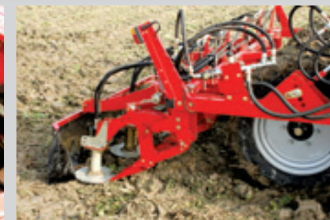
Achter de poetsassen zitten hydraulisch aangedreven nakoppers, scherpe snijschijven.
