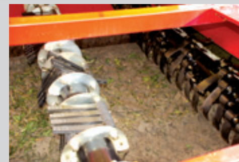
Rechts de poetsas met metalen klepels, links met kunststof klepels.
