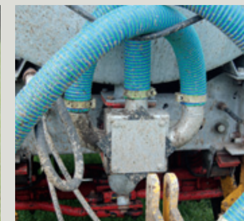
Via een verdeelstuk wordt de mest over de drie elementen verdeeld.
