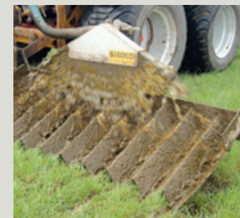
Via spuitmondjes wordt de mest over de golfplaat verdeeld. Dat gaat bij dunne mest beter dan bij dikke mest.
