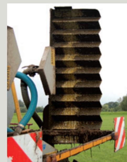
Via spuitmondjes wordt de mest over de golfplaat verdeeld. Dat gaat bij dunne mest beter dan bij dikke mest.
