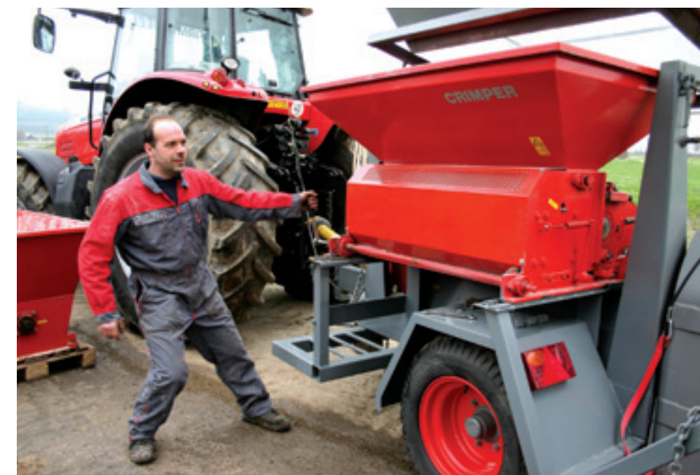
Cassettes wisselen doe je in een handomdraai. De trechter kantel je iets weg en de cassette rol je er onder vandaan. Met een heftruck of verreicher neem je hem weg en plaats je een andere.
