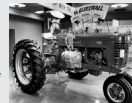
▲ De International Harvester 400 kon in 1954 uitgerust worden met de Electrall-generator die werktuigen van stroom voorzorg.
