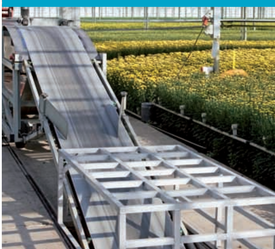
De geboste santini's gaan via een transportband onder het pad naar de schuur.
