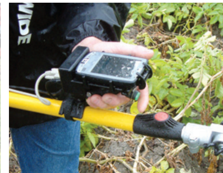
▲ Er is ook een Greenseeker als hand-heldapparaat. Met de groene knop activeer je hem.
