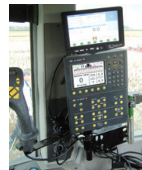
▲ Voor de aansturing van het Vario-Selektstelsel zit boven op de standaard spuitcomputer een touchscreen.
