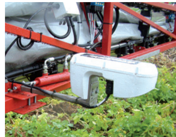
▲ Met de Greenseeker en de viervoudige, elektropneumatische spuitdoppen neemt het aantal draden, slangen en leidingen fors toe.
