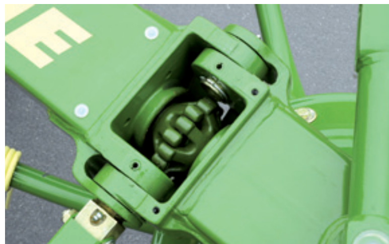
Door de vingerkoppeling kan de schudder in elke stand draaien.
