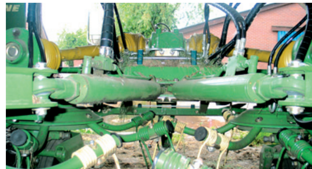
Twee cilinders in het midden van de schudder zorgen ervoor dat de framehelften naar elkaar toe getrokken worden en zo wordt de machine ingeklapt.
