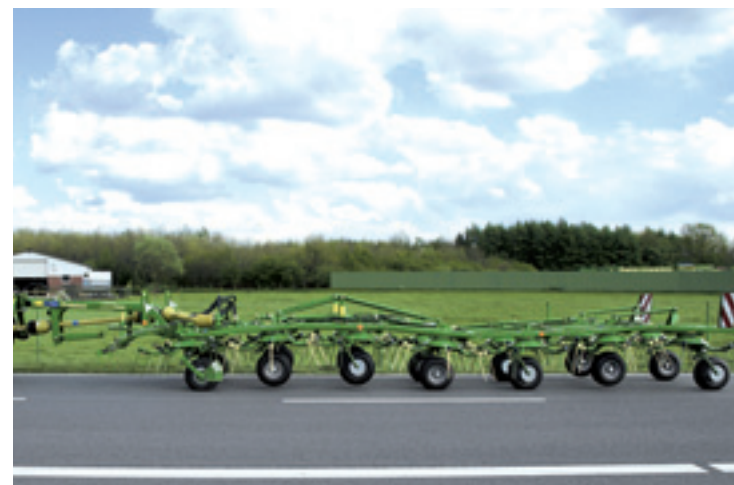
De machine tilt op de weg enkele wielen op zodat er een tandemas overblijft met aan de voor- en achterkant zwenkwielen voor stabiel weggedrag.
