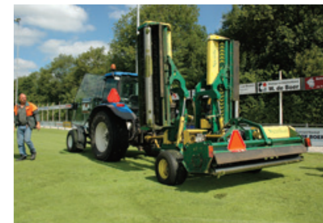
In transport klappt de driedelige maaier hydraulisch op. De aandrijving wordt elektrisch automatisch in- en uitgeschakeld.
