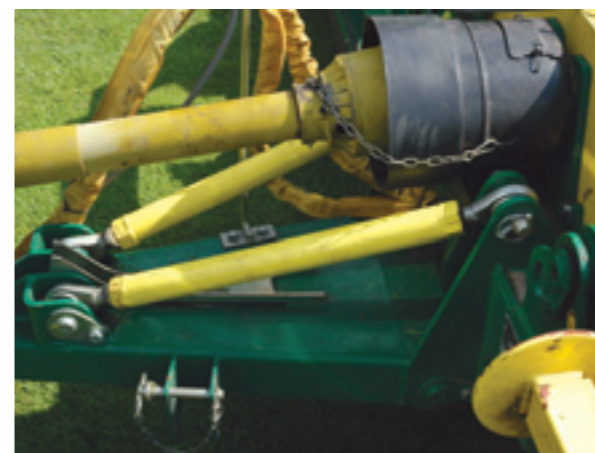
De maaihoogte wordt afgesteld met twee draadspindels. Daardoor draait de totale machine iets voor- of achterover ten opzichte van de steunrollen achterop en verandert de maaihoogte.
