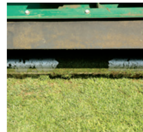
De klepelmaaier steunt over de volle breedte op een massieve rol. Deze wordt schoongehouden door een staal-draad. Bijkomend effect is dat het veld ook steeds wat wordt gerold.
