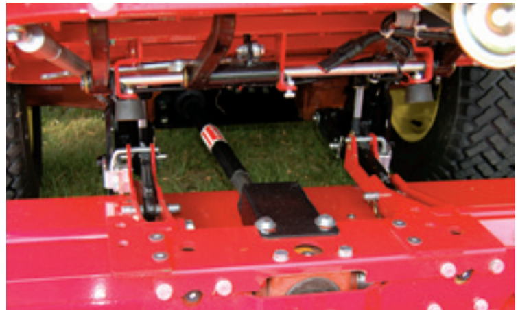
Op het oog zit het frontmaaidek aan te lichte draagarmpjes vast.
