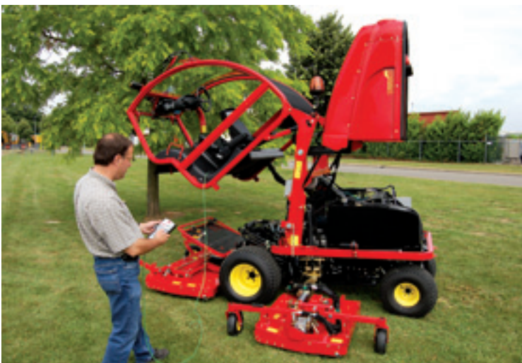
Met een afstandsbediening is de hele machine 'open te klappen'.
