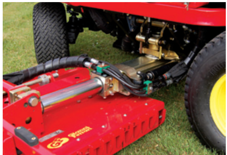
Via een hydraulische cilinder is het zijmaaidek zo'n 30 cm schuifbaar.
